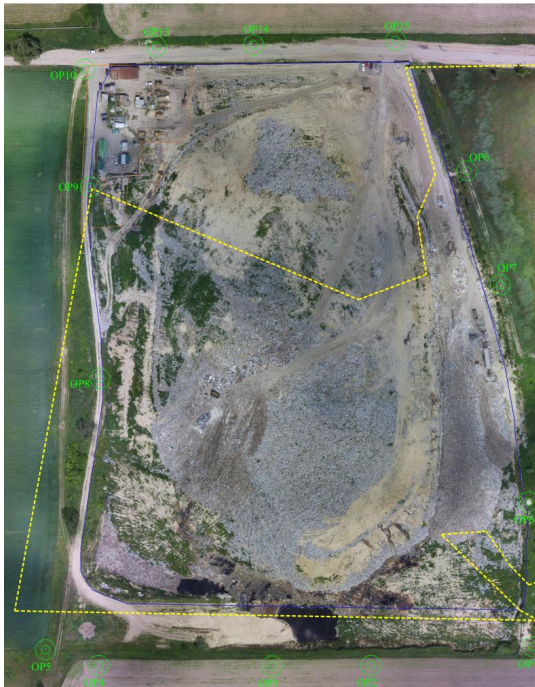
Рис. 3. Опорні точки позначені зеленими кружечками та нумерацією від 1 до 15. Фактична межа полігону позначена лінією синього кольору, а межі земельної ділянки з кадастровим номером 8000000000:02:010:5289 — пунктирною лінією жовтого кольору.
