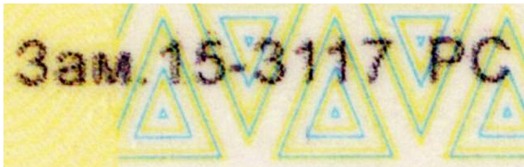
Рис. 4. Фрагмент підробленого бланка, який виготовлений з використанням струминного принтеру
