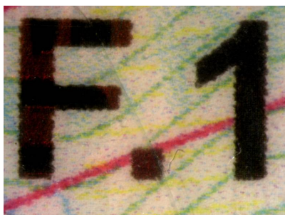
Рис. 1. Фрагмент свідоцтва про реєстрацію транспортного засобу, оформленого на підробленому бланку, який виготовлений з використанням струминного принтеру
