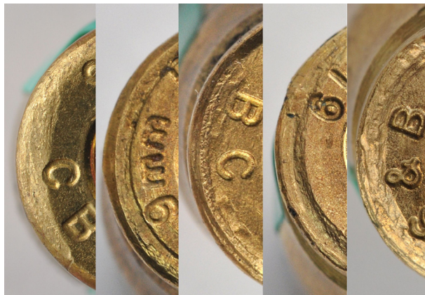
Рис. 5. Отпечаток формы чашечки патронного упора (различные варианты)
