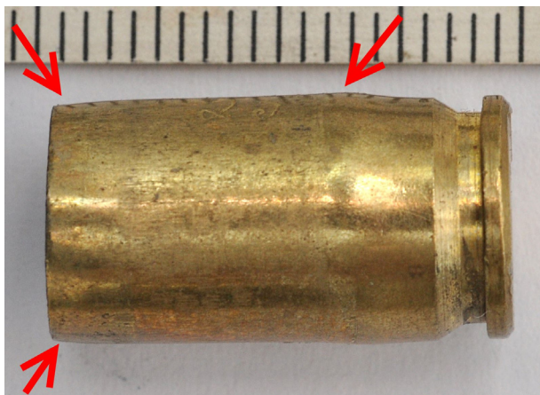
Рис. 6. Деформация гильзы из-за несоответствия формы патронника
