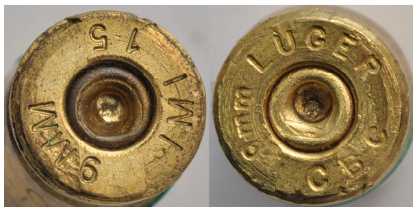
Рис. 3. Следы выстрела на доньшке гильзы выстреленной из самодельного пистолет-пулемета (на примере двух различных образцов)
