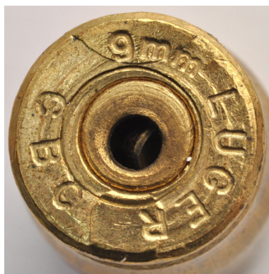
Рис. 4. Следы выстрела на доньшке гильзы выстреленной из самодельного пистолет-пулемета – перфорированный капсюль
