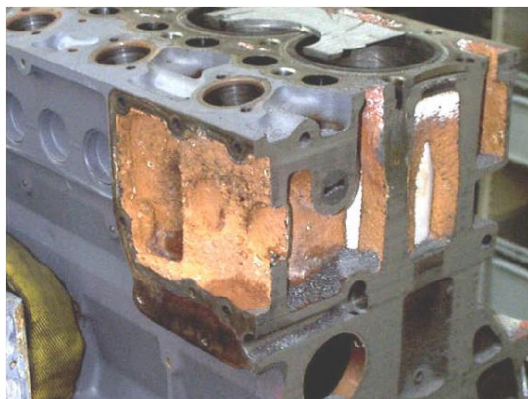
Рис. 1. Зовнішній вигляд продуктів корозії на системі охолодження двигунів внутрішнього згоряння
