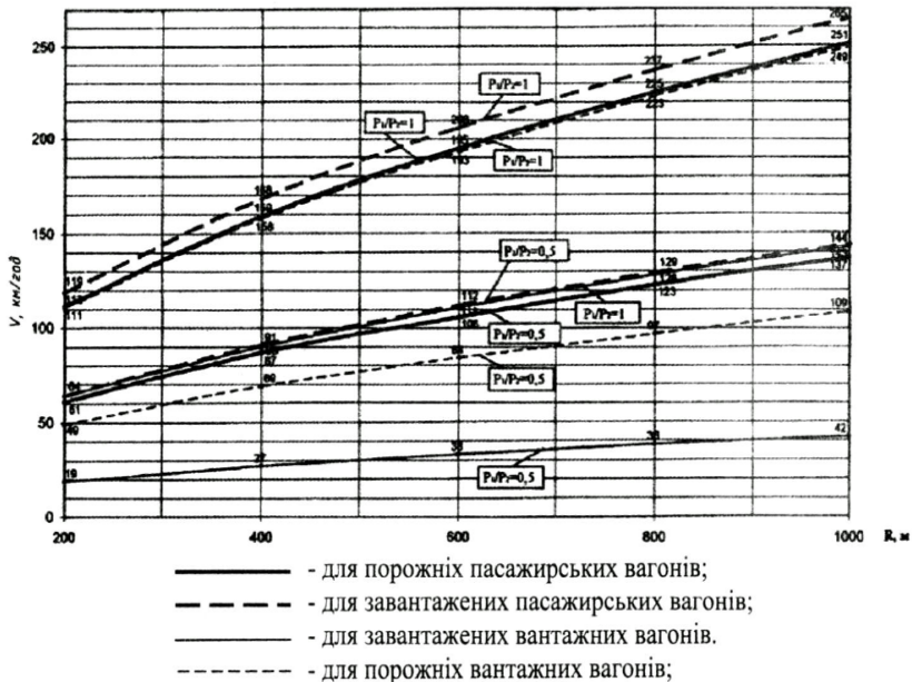
Рис. 3. Графіки залежності допустимої швидкості руху стрілочними переводами за умови недопущення наповзання колеса на рейку при нормативному значенні коефіцієнта стійкості K_{уст}^{нап} = 1,5
