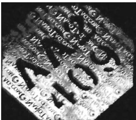
Рис. Збільшене зображення нікелевого диска із зображенням ідентифікаційного коду маркованого об'єкта
