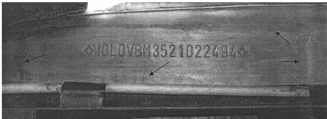
Рис. 5. Пример замены части детали кузова (Opel Omega) с идентификационным номером (стрелками указаны выявленные способом электрохимического травления скрытые сварные швы)
