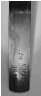
Рис. 22. Сліди пальців рук, виявлені за допомогою чотириокису рутенію на непофарбованій поверхні важеля (час — 2 год)
