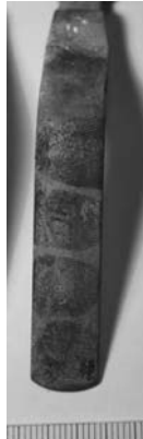
Рис. 17. Слід пальця руки, виявлений за допомогою сажі на непофарбованій поверхні важеля зі слідами корозії (час — 2 год)
