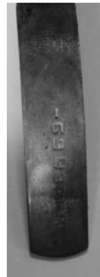
Рис. 25. Сліди пальців рук, виявлені за допомогою чотириокису рутенію на непофарбованій поверхні важеля (час — 2 год)
