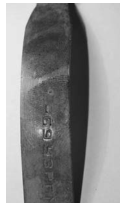
Рис. 11. Сліди пальців рук, виявлені за допомогою сажі на непофарбованій поверхні важеля (час — 1 год)
