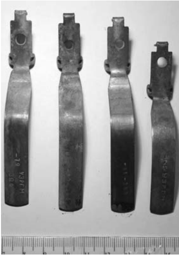
Рис. 26. Важелі після їх обробки за допомогою сажі (час — 4 год)
