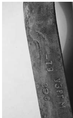
Рис. 10. Сліди пальців рук, виявлені за допомогою сажі на непофарбованій поверхні важеля зі слідами корозії (час — 1 год)
