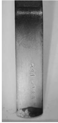
Рис. 13. Слід пальця руки, виявлений за допомогою чотириокису рутенію на пофарбованій поверхні важеля (час — 1 год)
