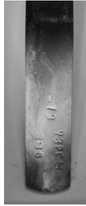
Рис. 14. Сліди пальців рук, виявлені за допомогою чотириокису рутенію на непофарбованій поверхні важеля (час — 1 год)
