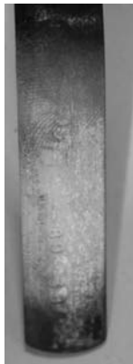
Рис. 23. Сліди пальців рук, виявлені за допомогою чотириокису рутенію на непофарбованій поверхні важеля зі слідами корозії (час — 2 год)
