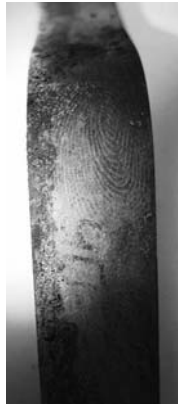
Рис. 7. Слід пальця руки, виявлений за допомогою окису цинку на непофарбованій поверхні важеля зі слідами корозії (час — 1 год)
