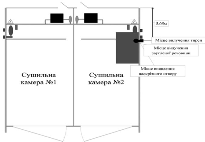
Рис. 8. Схема № 8 з позначенням місць видалення зразків тирси та зугленої речовини для проведення подальших хімічних досліджень
