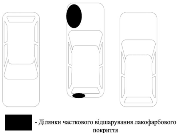
Рис. 3. Схема № 3 з ділянками з частковим відшаруванням лакофарбового покриття
