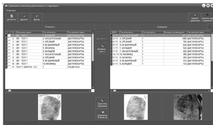
Рис. 9. Рабочее окно СПС со сформированным списком пар сравнения (один проверяемый след и 10 оттисков пальцев с дактилокарты), ранжированным по степени сходства между узорами (в правой части)
