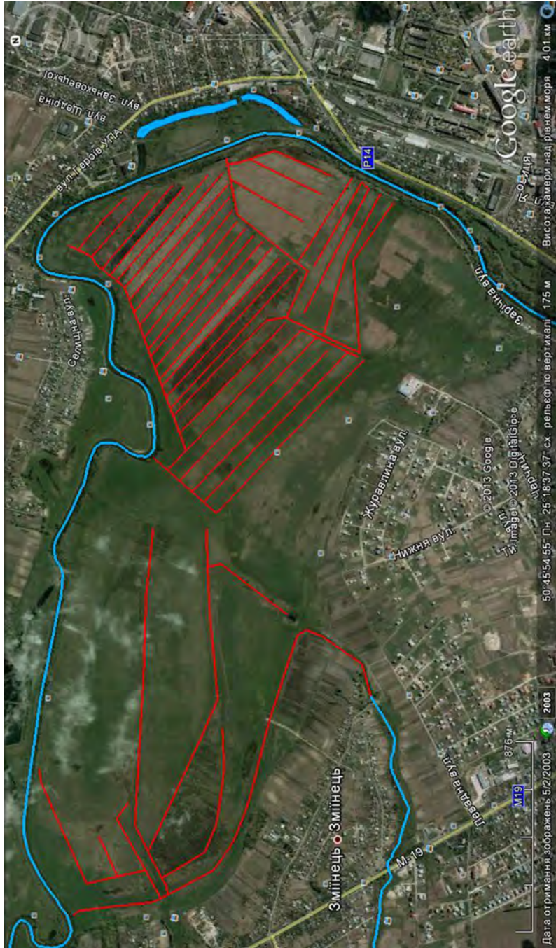
Рис. 2. Каналізована ділянка русла річки Стир і осушувальні канали (м.Луцьк)
