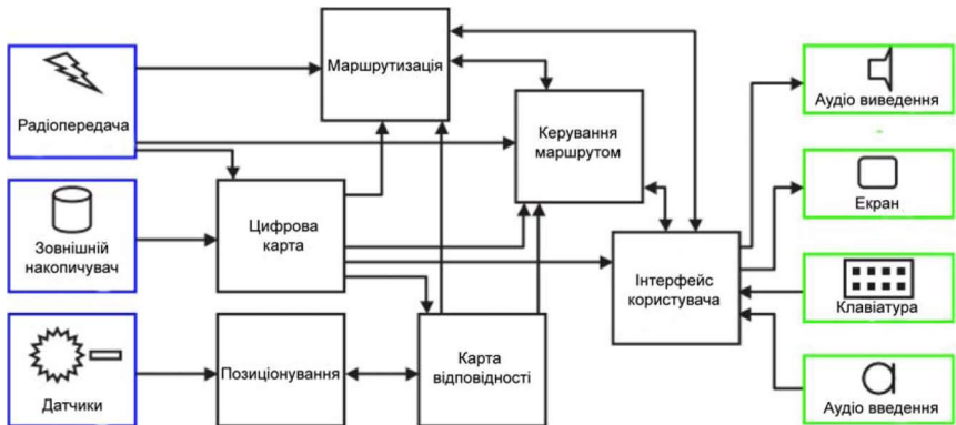
Рис. 1. Компоненти сучасних навігаційних систем
