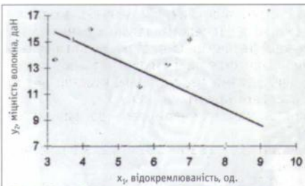
Рис. 2 — Залежність міцності волокна від відокремлюваності
