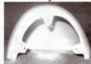
Рис.1 – Захисний носок з дюралюмінію із захисним покриттям: а – вид зверху, б – вид знизу
