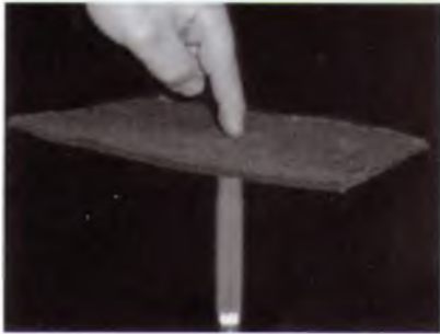
Тепловий ізолятор Aspen's Pyrogel AR5401 в дії (температура полум'я 1000°C)
