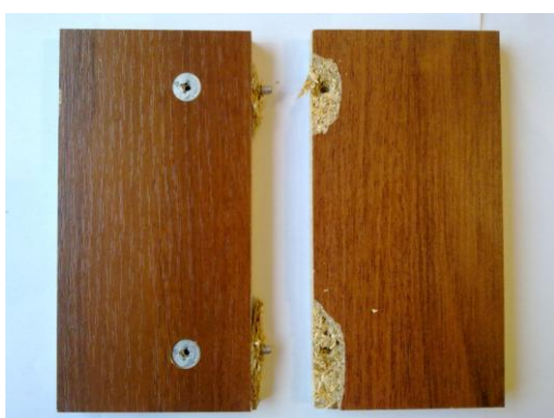
Рис. 4. Вигляд зразка з'єднання мініфіксом без букші після випробувань
