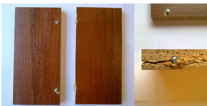
Рис. 5. Вигляд зразка з'єднання конфірматом після випробувань
