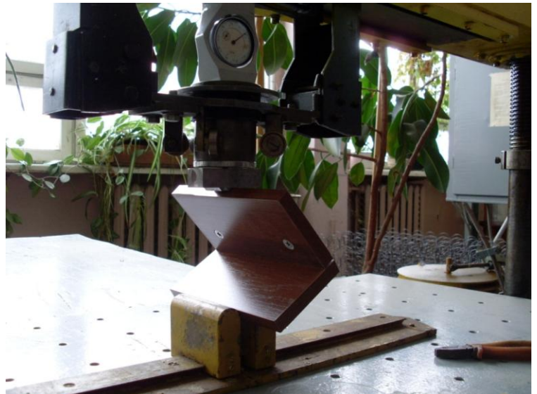
Рис. 3. Процес випробування кутових з'єднань корпусних меблів
