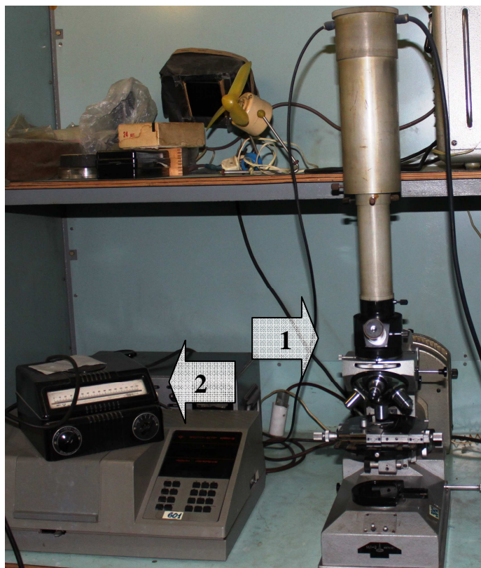
Рис. 1. Люмінесцентний мікроскоп (1), дообладнаний лічильником фотонів (2) для реєстрації інтенсивності флуоресценції листків
