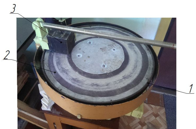
Рис. 3. Випробувальна машина для проведення дослідження з визначення показника стирання деревини
