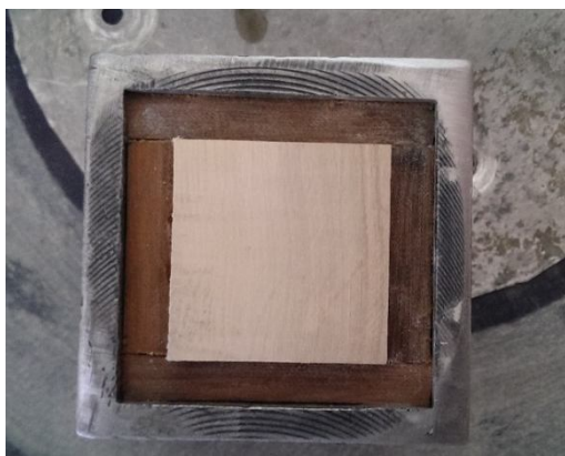
Рис. 2. Зразок деревини для проведення випробувань, закріплений у вантажі
