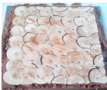
Рис. 4. Плита з ДПК, запресована за 170 °С
