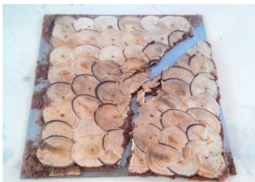
Рис. 3. Розірвана плита, запресована за 190 °С
