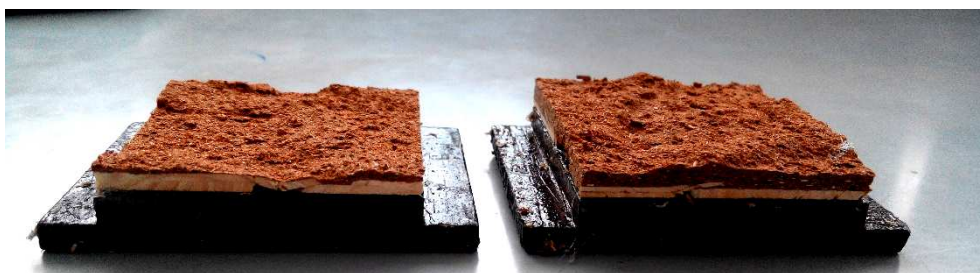
Рис. 6. Розірваний зразок при дослідженні межі міцності на розтяг
