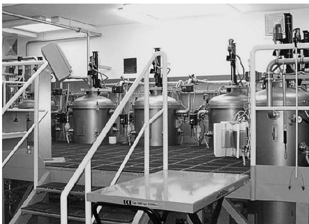
Rys. 1. Instalacja Bookkeeper w Bibliotece Narodowej w Warszawie.
