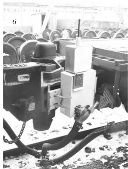
Рис. 16. Тройник 230Д.30.300: а — тройник 230Д.30.300; б — тройник, установленный между вагонами
