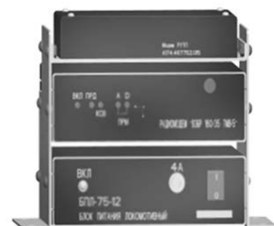
Рис. 7. Модемы РУТП А174.467752.015, 1Р23С/В «ВЭБР 160/35» и блок питания локомотивный БПЛ-75-12 в сборе
