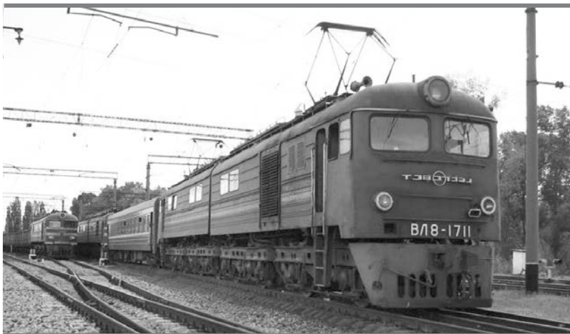
Рис. 15. Дослідний електровоз ВЛ8 із вагоном-лабораторією й складом вагонів вантажного поїзда
