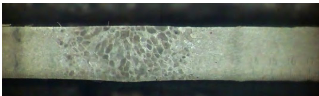
Рис. 4. Вплив магнітної стабілізації дуги на ширину швів та глибину проплавлення
