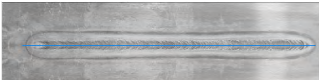
Рис. 3. Параметри формування швів при зварюванні у звичайних умовах (а) та при зварюванні з магнітною стабілізацією дуги (б)
