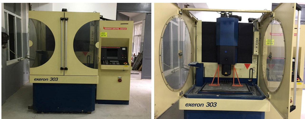
Рис. 4. Электроэрозионный специальный станок с программным управлением
