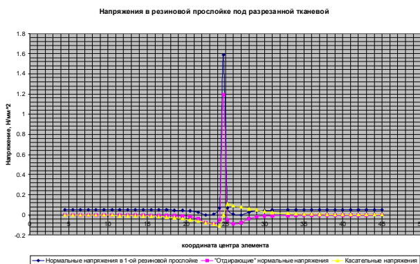
Рис. 13. Напруження в зв'язувальному шарі під розрізаними тканинними прокладками
