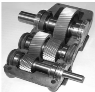
Рис. 5. Двосходитковий редуктор з некруглими колесами
