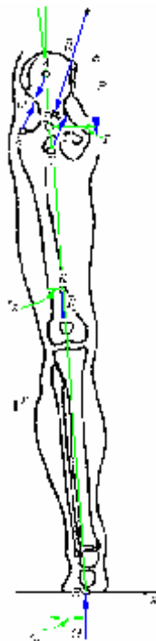
Рис. 1. Схема розподілу сил у нижній кінцівці людини в період одноопорного стояння
