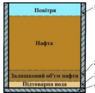
Рис. 1. Схема вирізання зразків з різних ділянок нафтового резервуара
