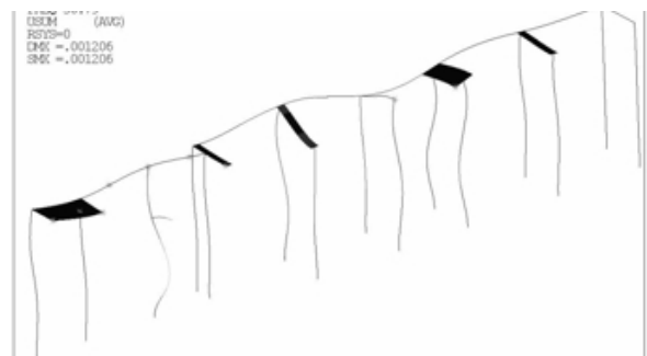
Рис. 12. Власна форма коливань фундаменту на частоті p = 47,11 Гц
