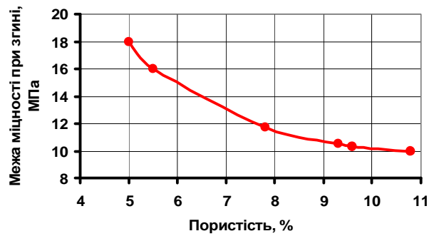
Рис. 1. Вплив пористості на міцність при згині графітізованого матеріалу з SiC-WC покриттям
