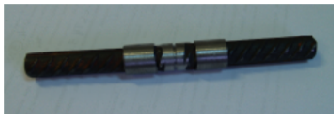
Рис. 1. Загальний вигляд зразка з опресованими втулками після проточування
