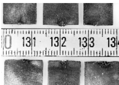
Рис. 2. Свинцеві зразки після оброблення в ближньому полі ГДВ
