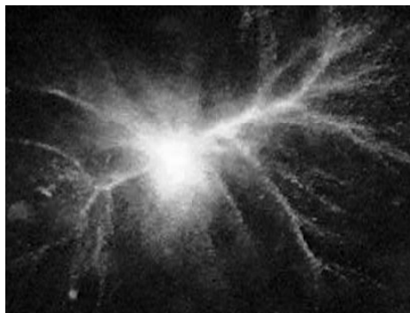
Рис. 1. Функціональна схема експерименту (а), фотографія звуколюмінесценції рідини у фокусній плямі випромінювача (б)
