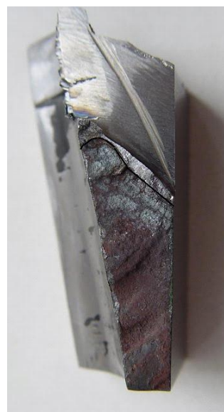
Рис. 6. Поверхня експлуатаційної тріщини №36 (рис. 2) в перемичці між отворами діаметром 20 мм
