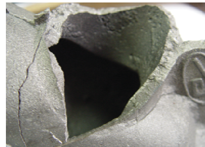
Рис. 2. Фрактограми поверхні пароперегрівача зі сформованими експлуатаційними тріщинами: а,б – окислена поверхня; в,г – експлуатаційні тріщини
