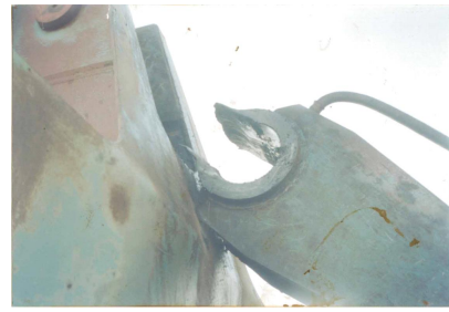
Рис. 5. Вихід тяги шарнірного з'єднання з коромислом через руйнування втулки корпусу тяги коромисла внаслідок зношування шарніру «тяга коромисла-коромисло»
