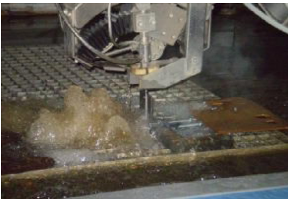
Рис. 6. Встановлення досліджуваного зразка на робочий стіл гідрорізної машини ЛСК-400-5
