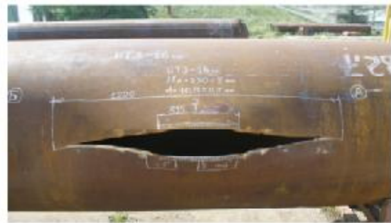
Рис. 4. Поверхня руйнування труби зі штучно створеним концентратором напружень
