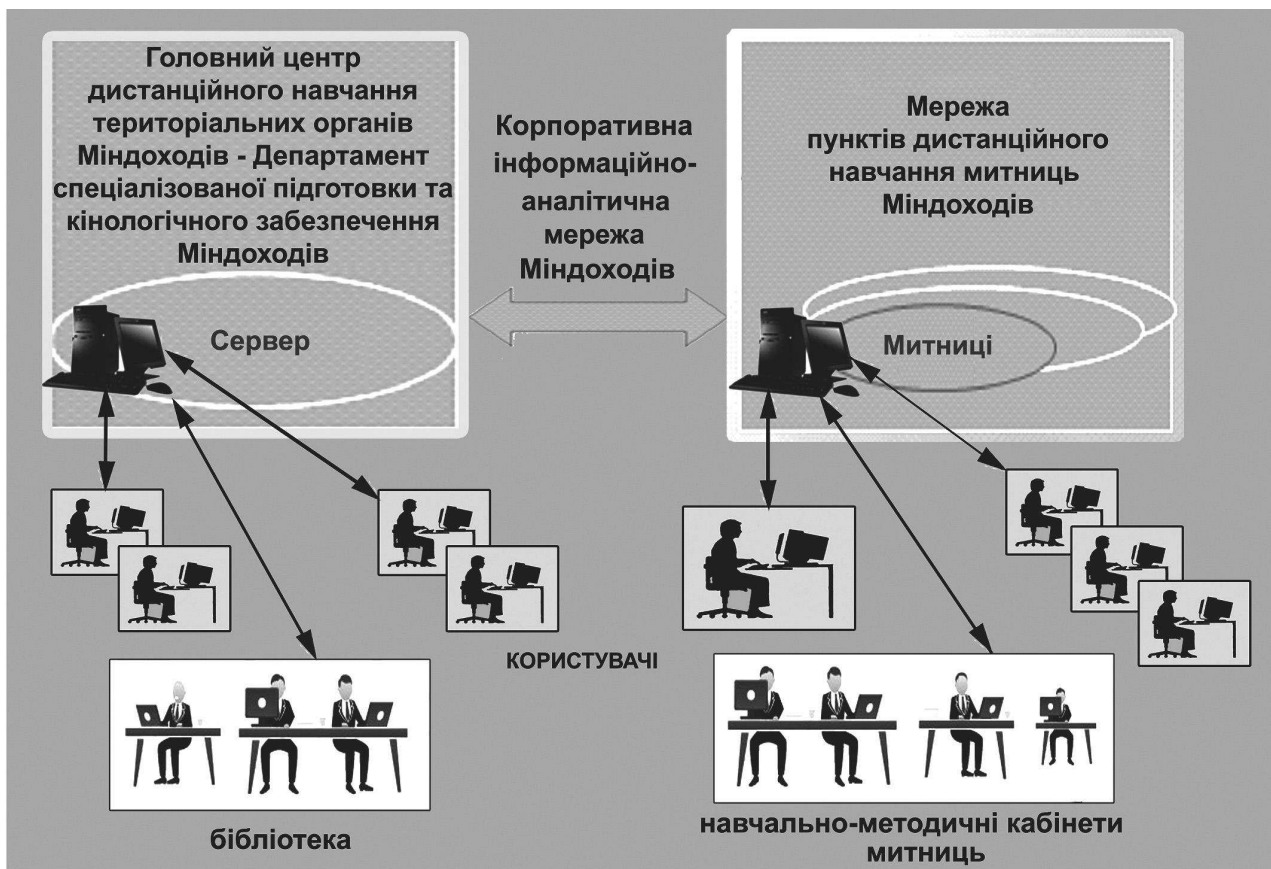
Рис. 1. Схема забезпечення віддаленого доступу персоналу митниць Міндоходів до Головного центру дистанційного навчання – ПК «Навчально-методичний кабінет», з використанням корпоративної інформаційно-аналітичної мережі відомства
