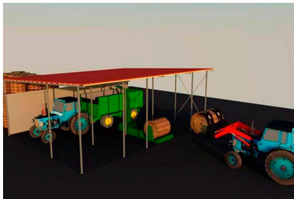
Рисунок 1 – Пункт зберігання та подрібнювання соломи зі стаціонарним подрібнювачем рулонів
