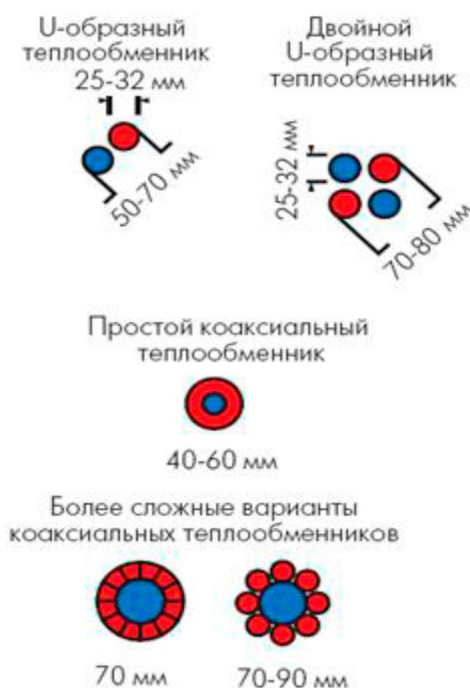
Рисунок 5 – Перетин різних типів вертикальних ґрунтових теплообмінників
