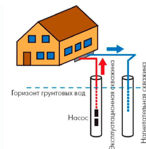
Рисунок 1 – Схема відкритої системи використання низькопотенційної теплової енергії ґрунтових вод
