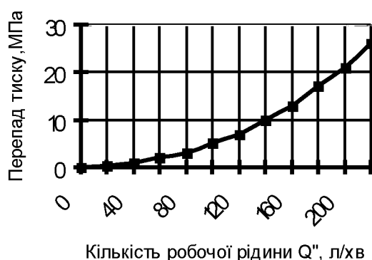
Рисунок 8 – Тарувальна характеристика витратоміра змінного перепаду тиску
