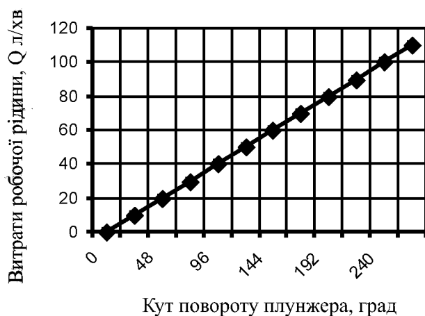
Рисунок 6 – Тарувальна характеристика витратоміра постійного перепаду тиску
