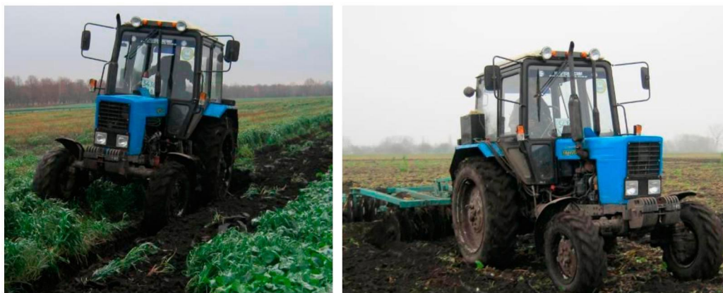
Рисунок 5 – Трактор Кий-14102 обладнаний системою двохступеневого підігріву палива на виконанні технологічних операцій при використанні чистого дизельного біопалива
