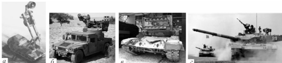
Рис. 1. Бойові лазери на броньованому шасі: Німеччині (а), США (б), Росії (в) і Китаю (г).
