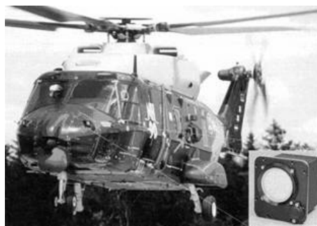
Рис. 2. Система MILDS на вертолете NH-90.
