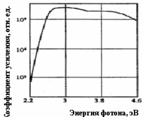
Рис. 5. Характеристика фоторезистора GaP:Cu.
