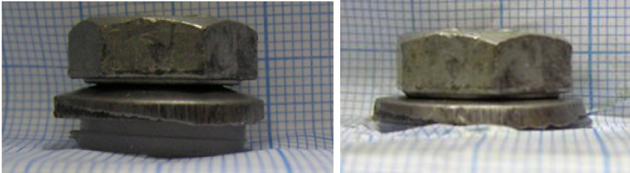
Рис. 5. Деформация пластиковой шайбы: а – начальное положение; б – деформация при затяжке
