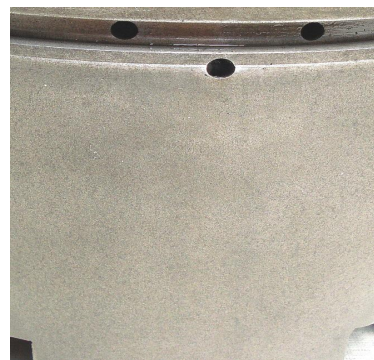
Рис.1. Боковая поверхность поршня К6S310DK преобразованная гальвано-плазменным методом [2]
