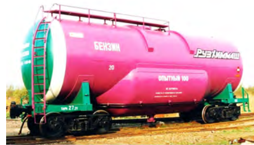
Рис. 7. Вагон-цистерна з нециліндричним котлом побудови Руххиммаш
