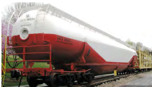
Рис. 8. Безрамный вагон-цистерна с котлом переменного сечения, США
