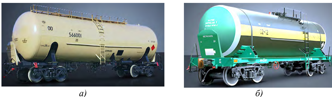
Рис.4. Вагоны-цистерны производства Уралвагонзавода: а) – безрамная; б) – рамная
