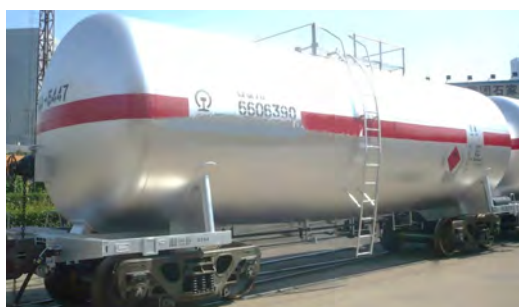
Рис. 10. Вагон-цистерна с нецилиндрическим котлом производства КНР
