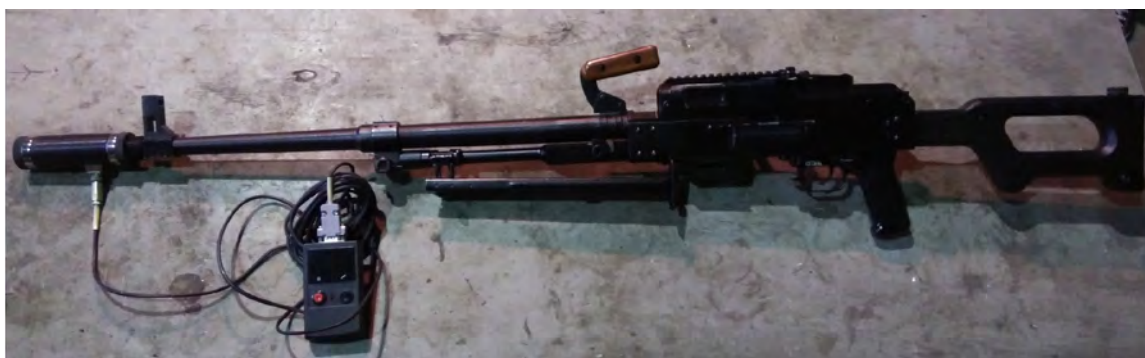
Рис. 2. Установка модуля регистрации ХЦ-7 на ствол стрелкового оружия
