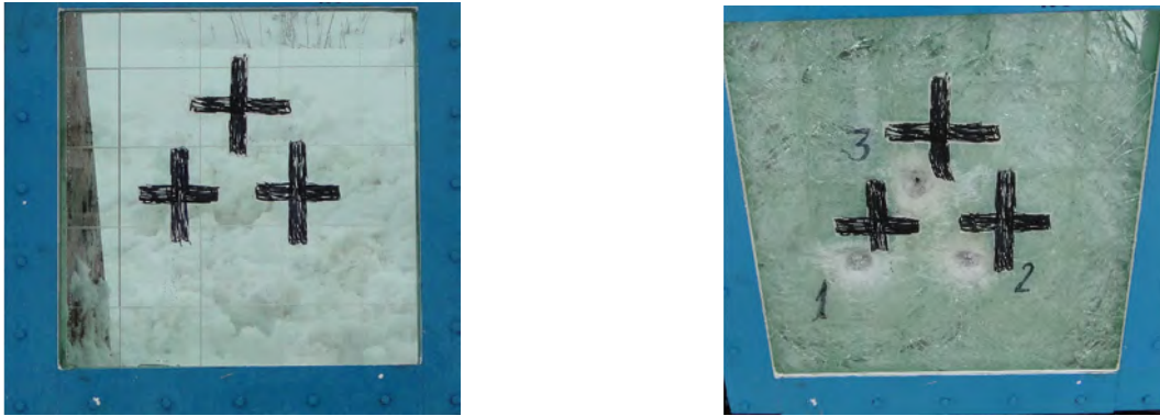
Рис. 2. Общий вид образца прозрачной брони на основе сапфира размером 500x500x56мм до (слева) и после (справа) пулевых испытаний, проведенных сотрудниками ГП «ХКБМ» согласно требований ДСТУ 4546:2006
