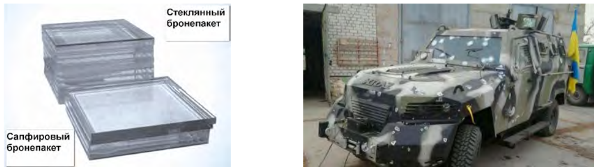
Рис. 1. Сравнение обычного бронестеклянного пакета и прозрачной брони на основе сапфира с одинаковым классом защиты (слева), расстрелянный бронемобиль "Когуар" с окнами из бронестекла (справа)
